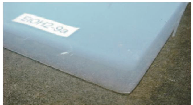
図 1 千葉大学で製作した 2 つの異なる密度を重層したエアロゲルの写真。ゲル下層は上層より密度が高く、それに伴い透明度も高い。
